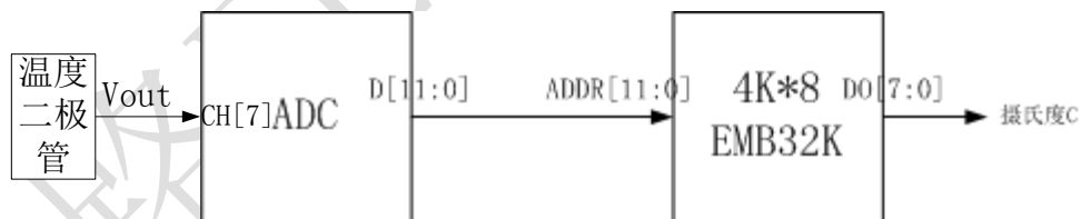
图 2.15-1 : 温度传感器 IP 框图
